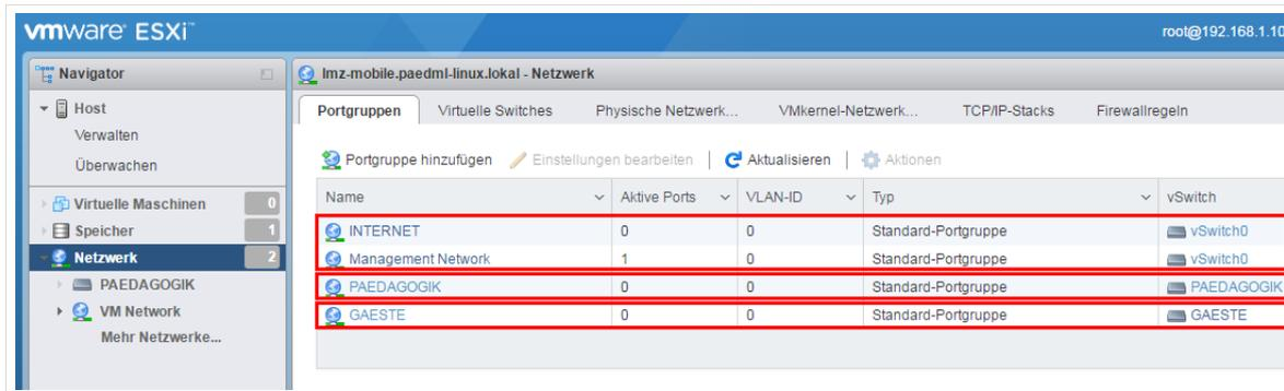
Abb. 49: Übersicht der auf dem Virtualisierungs-Host eingerichteten Netze
