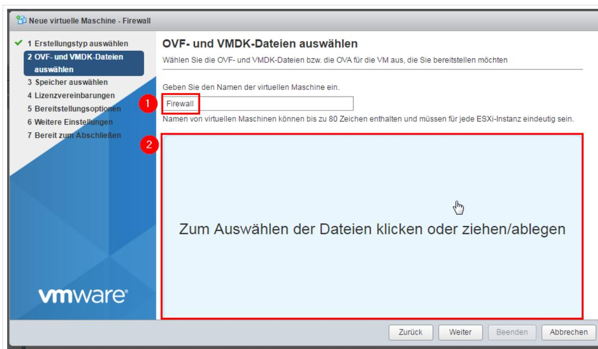
Abb. 52: OVF- und VMDK-Dateien für die VM „Firewall“ auswählen
