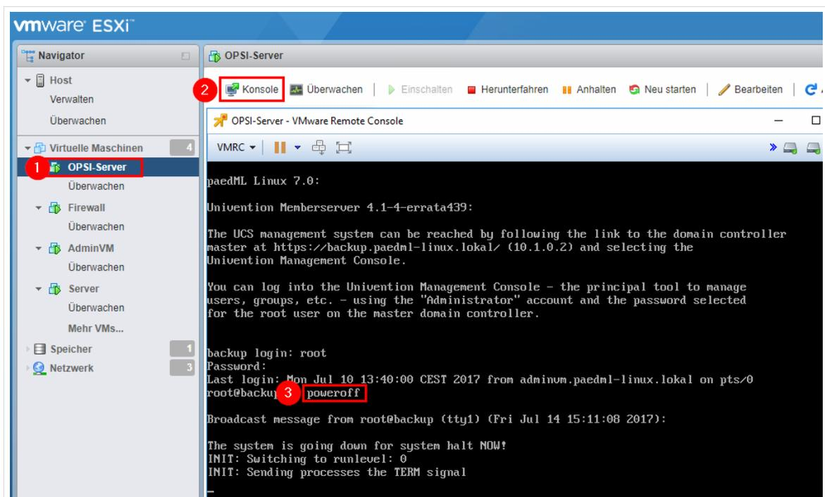
Abb. 143: Herunterfahren der VM Server bzw. Opsi-Server von der Textkonsole aus]
