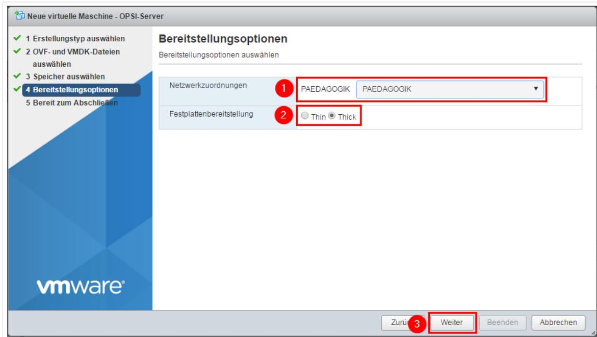
Abb. 72: Netzwerkzuordnungen und Auswahl des Festplattenformats „Thick“
