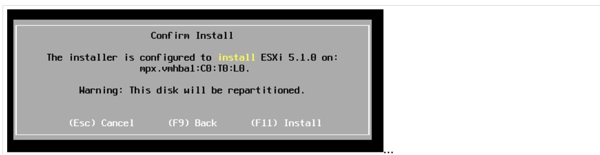
Abb. 10: Endgültige Bestätigung der Installation des Hypervisors
