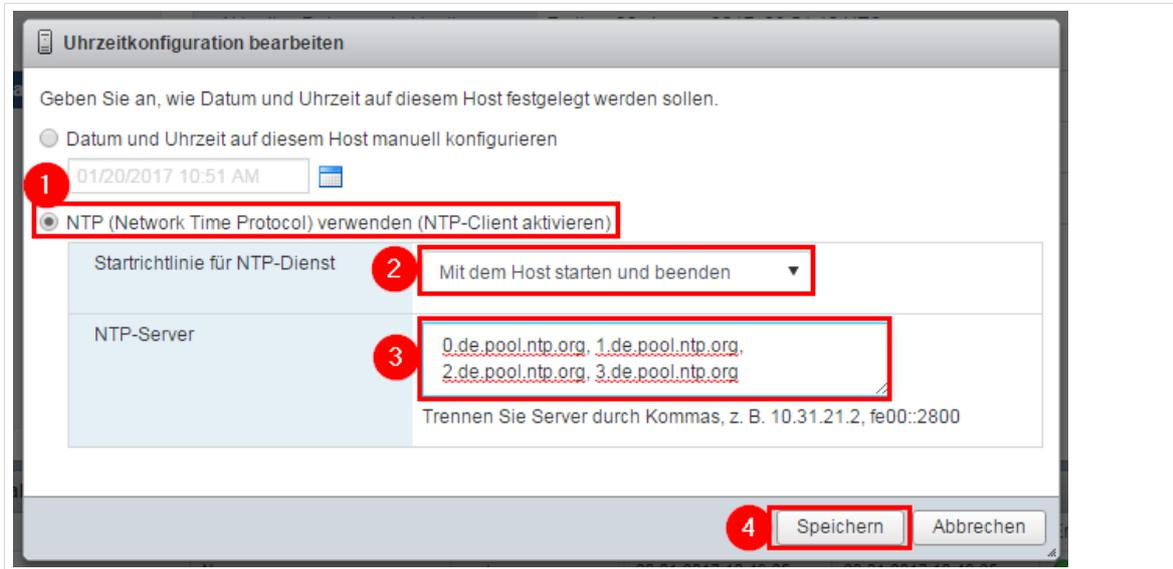
Abb. 38: NTP Client aktivieren, NTP-Server eintragen
