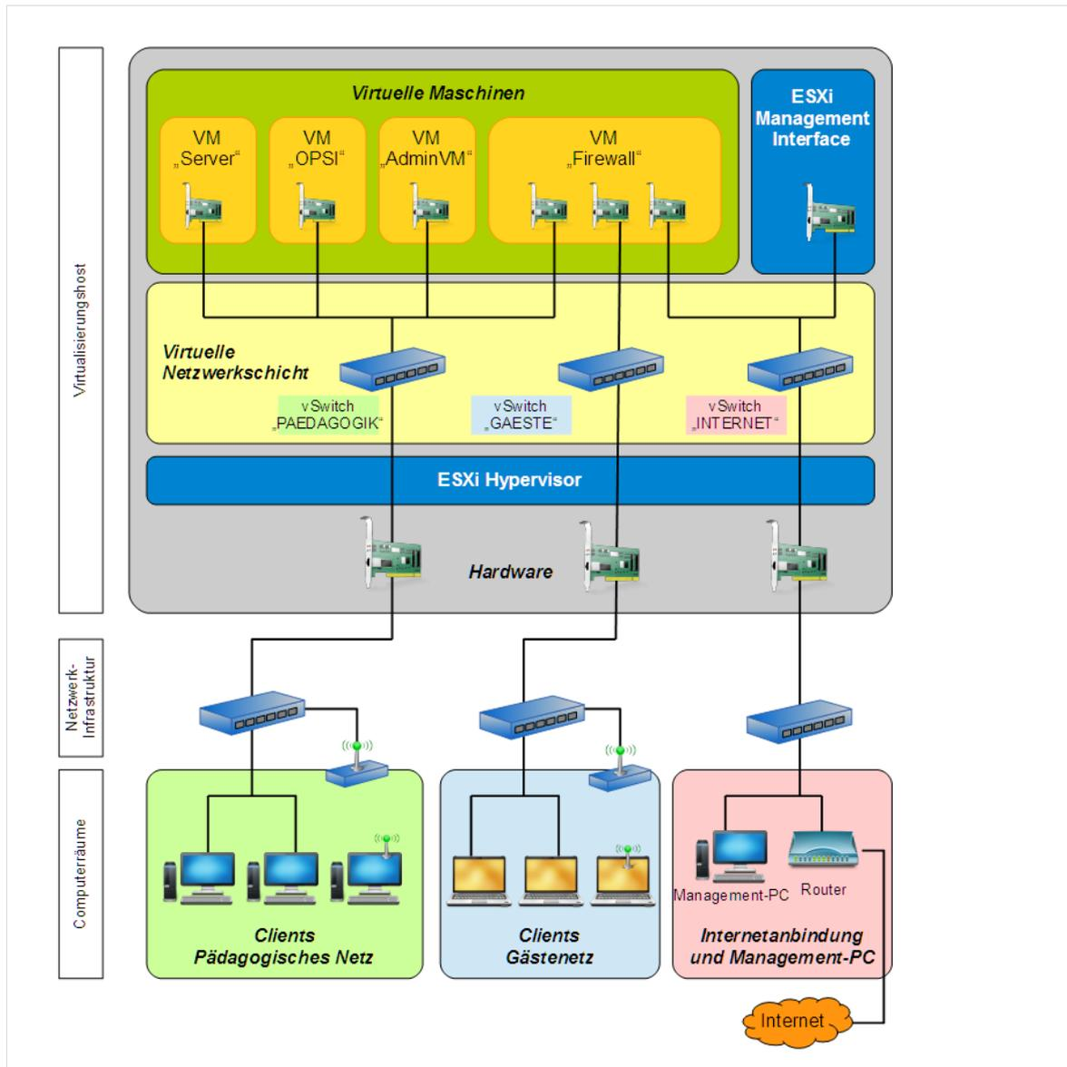
Abb. 1: Schematischer Aufbau der paedML Linux.
