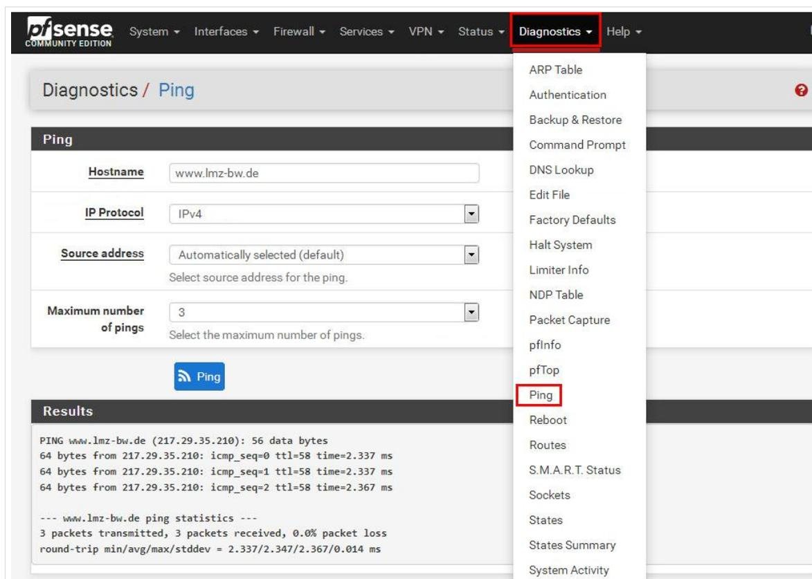
Abb. 101: Erfolgreicher Ping-Versuch auf [www.lmz-bw.de](http://www.lmz-bw.de)
