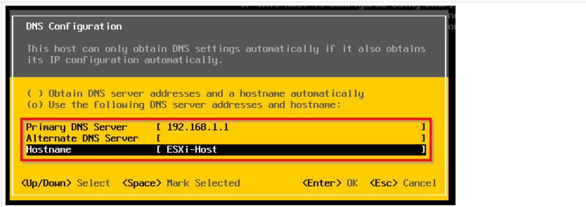
Abb. 24: Konfiguration von DNS und Hostname
