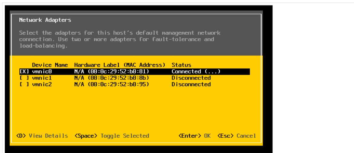
Abb. 18: Konfiguration der Netzwerkkarte für das „Management Network“
