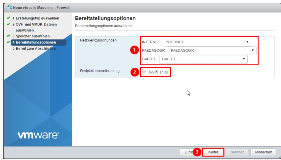
Abb. 56: Netzwerkzuordnungen und Auswahl des Festplattenformats „Thick“
