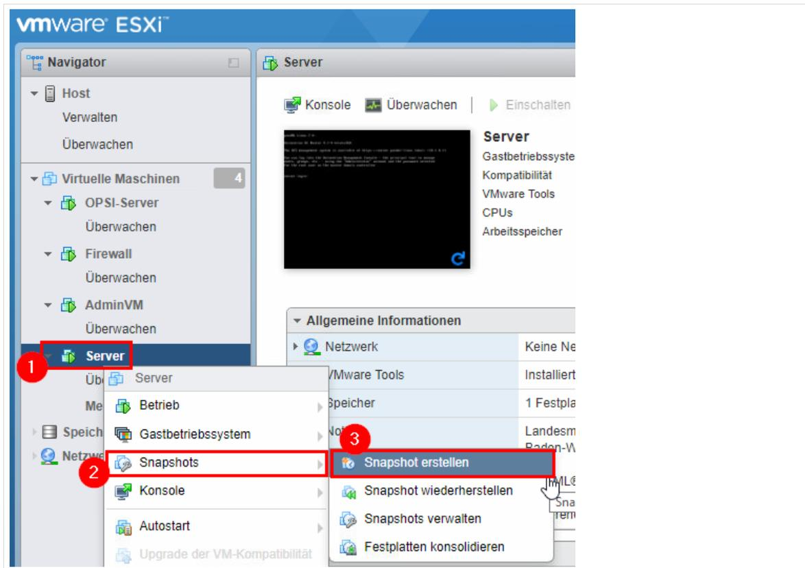
Abb. 151: Erstellen eines Snapshots der VM „Server“
