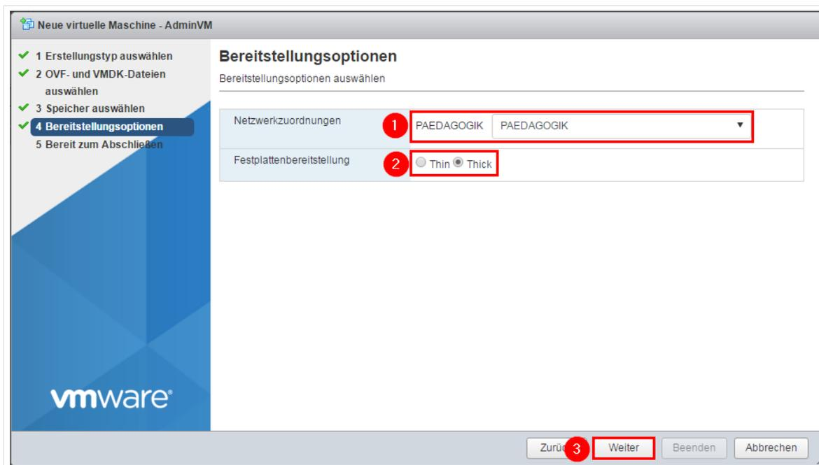
Abb. 80: Netzwerkzuordnungen und Auswahl des Festplattenformats „Thick“
