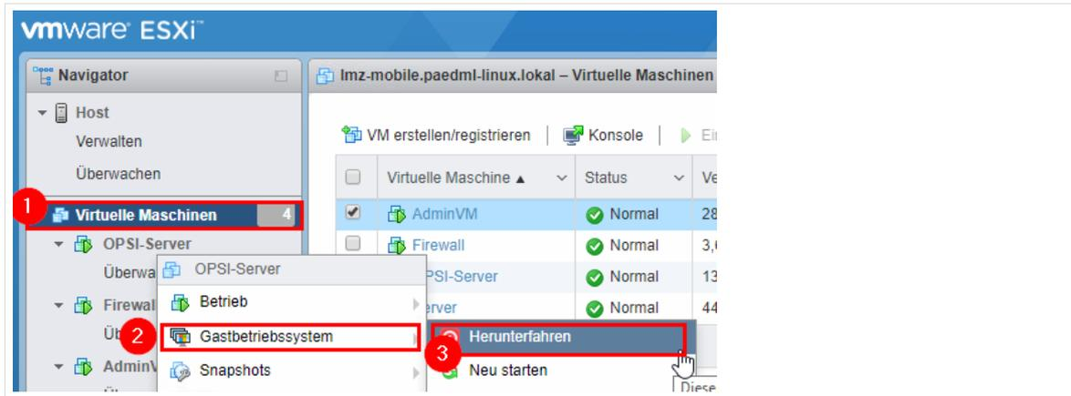
Abb. 146: Gastsystem über Kontextmenü herunterfahren
