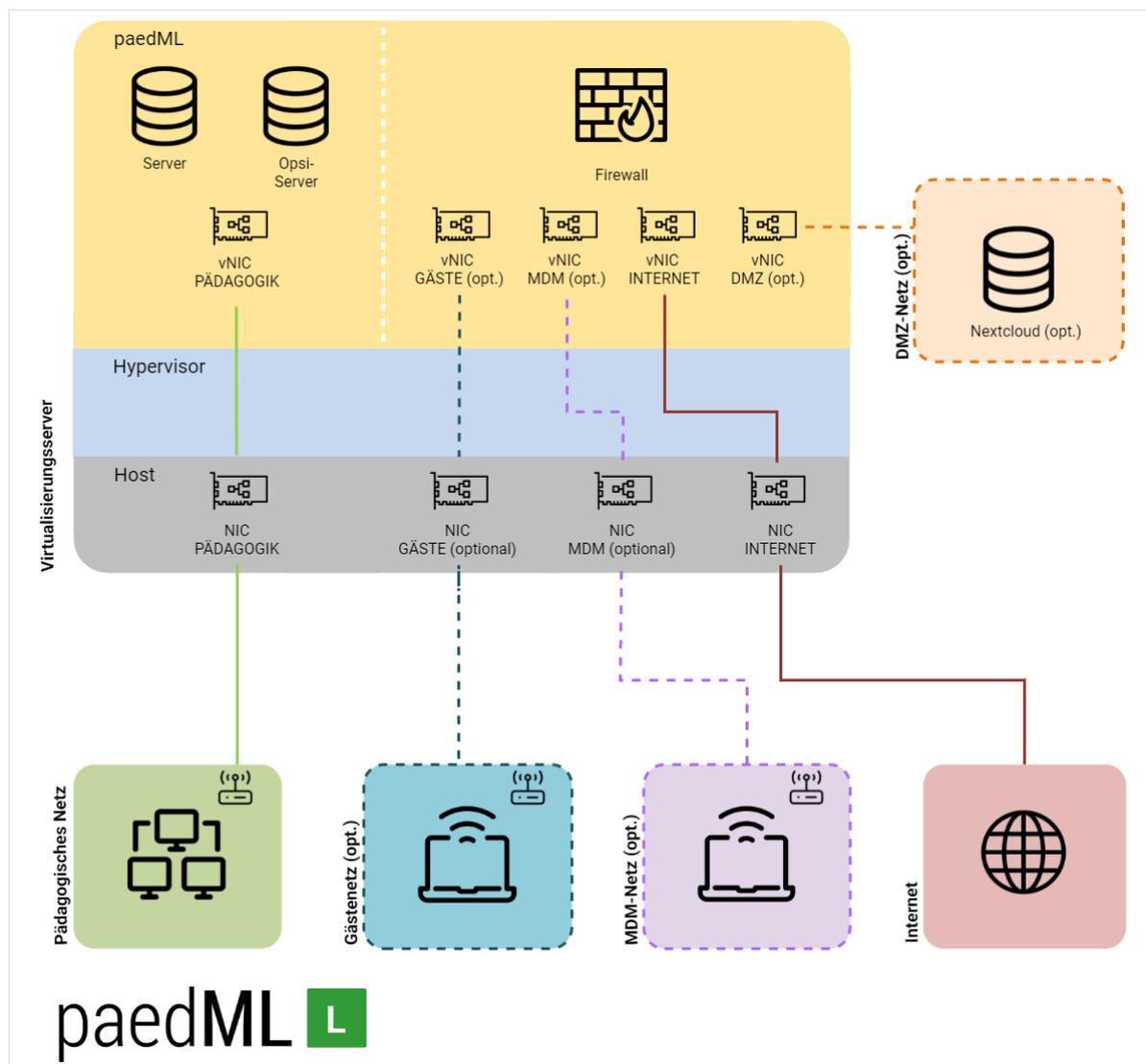
Abb. 1: Schematischer Aufbau der paedML Linux.
