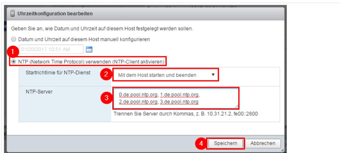
Abb. 36: NTP Client aktivieren, NTP-Server eintragen
