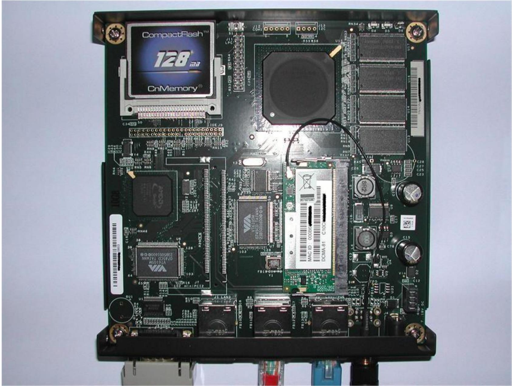
(Abbildung zeigt das ALIX Mainboard mit fertig montiertem WLAN miniPCI Modul und Antenne)
