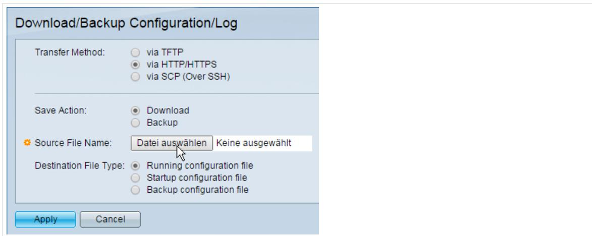
Abb. 38: Übertragung einer Konfigurationsdatei an den Switch
