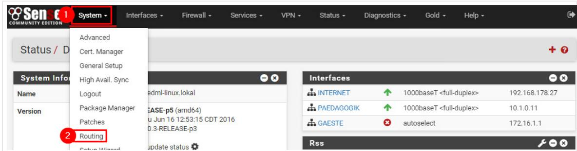
Abb. 56: Navigation zu den Routing-Einstellungen der Firewall
